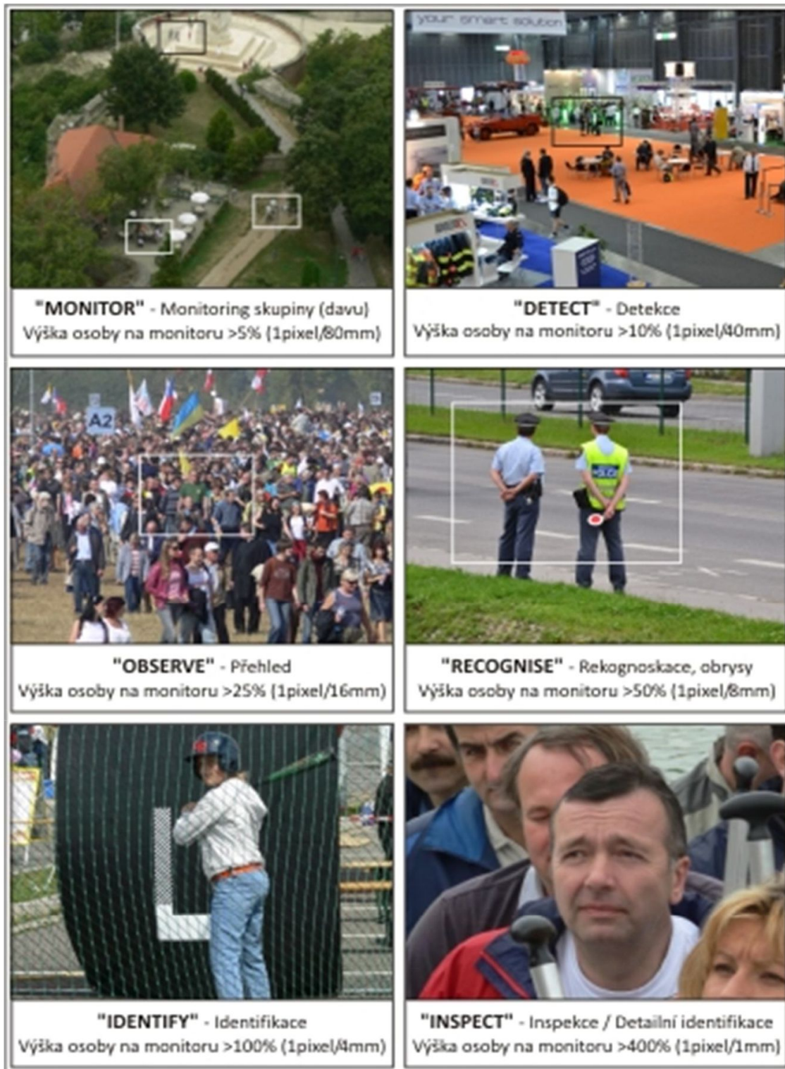
Obr. 6.: Stupně identifikace osoby dle revidované normy EN 50132-7 [12]
