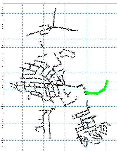
Obrázek 90: Přetížení úseků dešťové stoky VI a la dešť N5).
