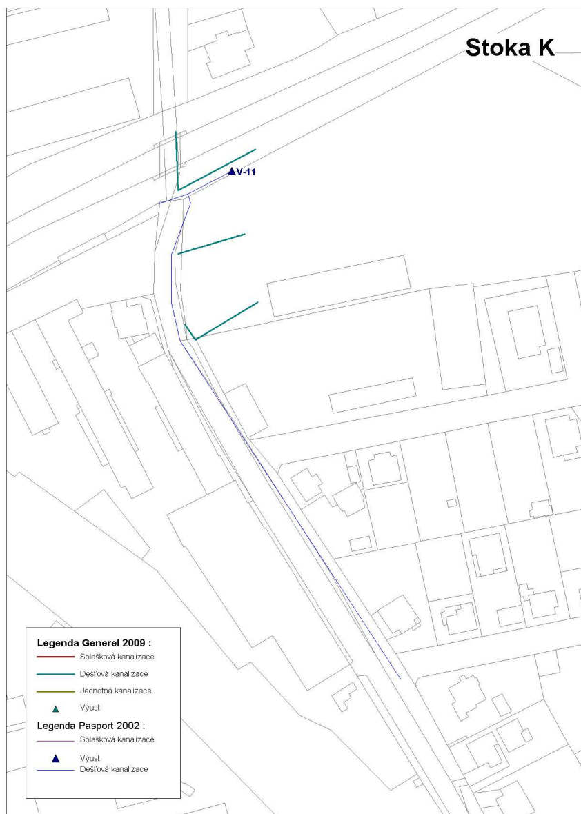
Obrázek 22: Zaměření a předpokládaný průběh dešťové stoky K.
