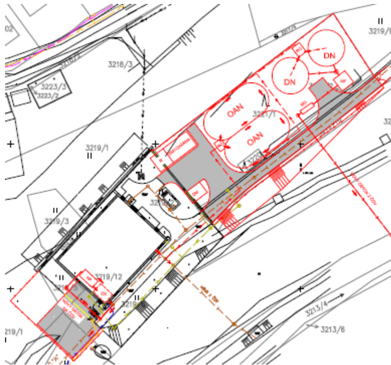
Obr. Situace rozšíření ČOV na 12 000 EO
