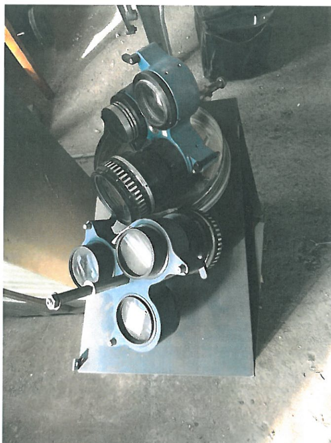
Revolver s objektivy k projektoru Meo 5XB
