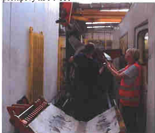
Měřicí místo M10: výměna materiálu k lisování - automatické zavedení a serížení – postupový lis PT 001
