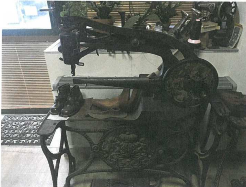
Opravárenský šicí stroj ramenný UNIVERSAL (1895)
