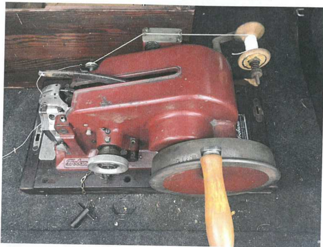
Šicí stroj FROBANA na kličku speciálně na rámečky podešve (1936)
