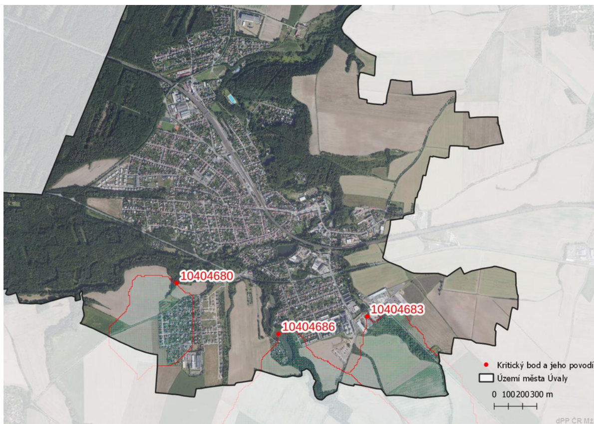
Obrázek 4: Zhodnocení vzniku přívalových povodní na území města Úvaly metodou kritických bodů
